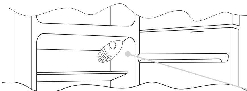
Le thermostat commandant l'appareil se trouve en haut à droite l'intérieur du réfrigérateur. Pour vérifier que l'appareil fonctionne, assurez-vous que le bouton du thermostat ne se trouve pas en position "0".
