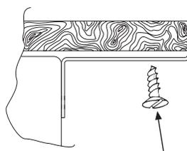
Fixez la partie inférieure de l'appareil à l'aide des vis fournies.
