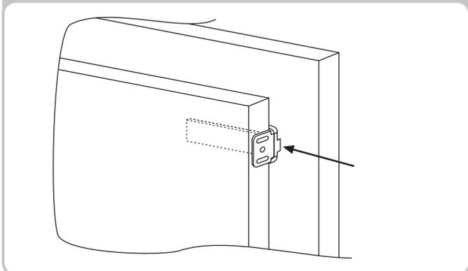
Marquez les points de fixation pour les vis et percez à l'aide d'un foret de diamètre 2.5.
