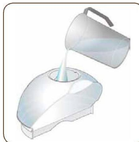
2. Verser la solution détartrante dans le réservoir à eau de la machine NESCAFÉ® Dolce Gusto®.
