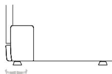
Lorsque l'appareil est mis en place, réglez les pieds (en les vissant ou en les dévissant) pour régler la hauteur du lave-vaisselle et le mettre à niveau. Dans tous les cas, l'appareil ne doit jamais être incliné de plus de 2°.
