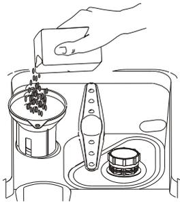
1. Otez le panier inférieur, dévissez et ôtez le bouchon du réservoir de sel.
