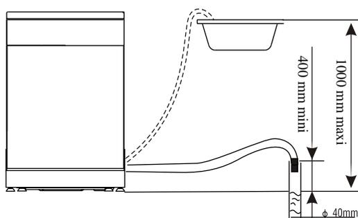
Introduisez le tuyau flexible de vidange dans un tuyau de vidange ayant 4 cm minimum de diamètre ou laissez-le se vider dans l'évier, en évitant soigneusement de le plier ou de le déformer. Utilisez le support en plastique spécial fourni avec l'appareil. L'évacuation et le tuyau doivent se trouver à une hauteur de 400÷1 000 mm sans être plongés dans l'eau.
