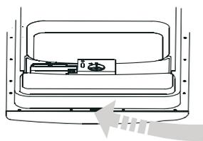
N'utilisez qu'un chiffon doux imbibé d'eau chaude pour nettoyer le pourtour de la porte. N'utilisez aucun type de nettoyant en bombe afin d'éviter que l'eau ne pénètre dans le verrou de la porte et dans les composants électriques.
