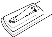
Retirez le couvercle du compartiment des piles à l'arrière de la télécommande, puis insérez R03 une pile AAA en respectant la polarité  $\oplus$  et  $\ominus$ .
