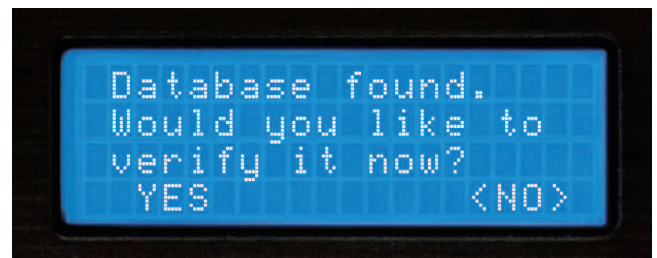
Fig 2.4 - Cuando añadida música a su dispositivo, la database debe ser verificada y actualizada para indexar las nuevas canciones.
