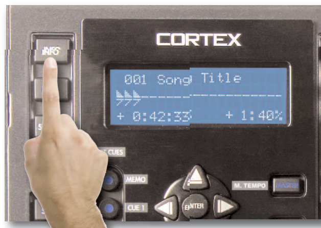
Fig 4.7 - La touche Info est utilisée pour afficher tous les attributs d'un morceau.
