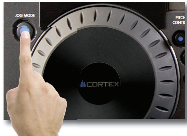
Abb. 5.8 - In den Jog Modus zum schnellen Vor- und Zurückspulen gelangt man mit der Jog Mode Taste
