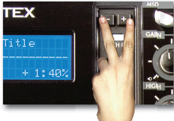
Fig 5.5 - Activation du Réglage de Vitesse (Pitch) On/Off en appuyant sur les deux touches simultanément.
