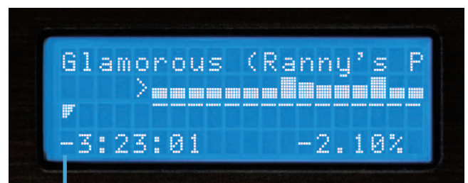
Abb. 4.6 - LCD Display und der Fortschrittsanzeiger im Zeitanzeigemodus "Verbleibende Zeit"
