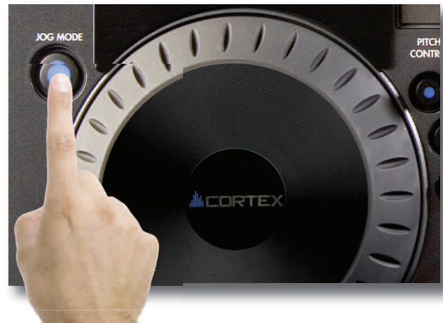
Fig 5.8 - Activer le Mode Recherche Rapide AV/AR à l'aide de la touche Jog Mode
