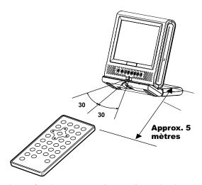
La télécommande peut fonctionner sur une distance d'approximativement 5 mètres.
