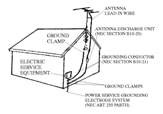
EXEMPLE DE RACCORDEMENT D'ANTENNE À LA TERRE SELON LE CODE ÉLECTRIQUE NATIONAL DES ÉTATS-UNIS
