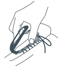
③ Fixez le module SDM à l'aide de la sangle noire. Le module doit reposer juste en dessous de l'endroit où se nouent les lacets et être suffisamment bien fixé pour rester en place pendant la séance d'exercices.
