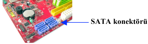
Şekil 2: 4 adet SATA konektörü bulunan Masaüstü PC anakartı. Her bir sistemdeki konektör sayısı değişecektir.
