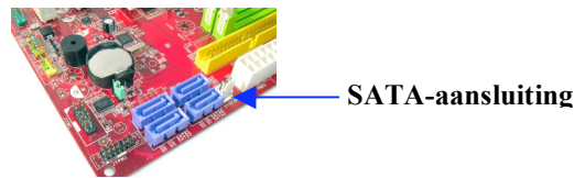
Figuur 2: Moederbord van een desktop-pc met 4 SATA-aansluitingen. Het aantal aansluitingen verschilt van systeem tot systeem.
