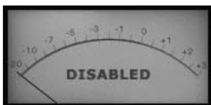
Figure 2 : Le 24/7-C est affiché avec tous les éclairages éteints et le message "Disabled" s'affiche dans le VU-mètre.
