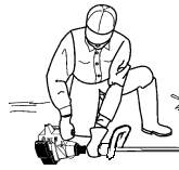
Position de Mise en Marche
