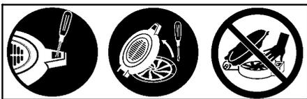
**⚠ AVERTISSEMENT:** Arrêtez le moteur avant d'ouvrir l'arrivée d'aspirateur. Le moteur doit être arrêté et les lames de l'impulseur ne doivent plus tourner pour éviter les blessures graves que peuvent causer les lames qui tournent. Soulevez doucement le bout du tournevis vers l'arrière de l'appareil à ouvrir la loquet en tirant sur le couvercle de l'arrivée de l'aspirateur avec l'autre main.
