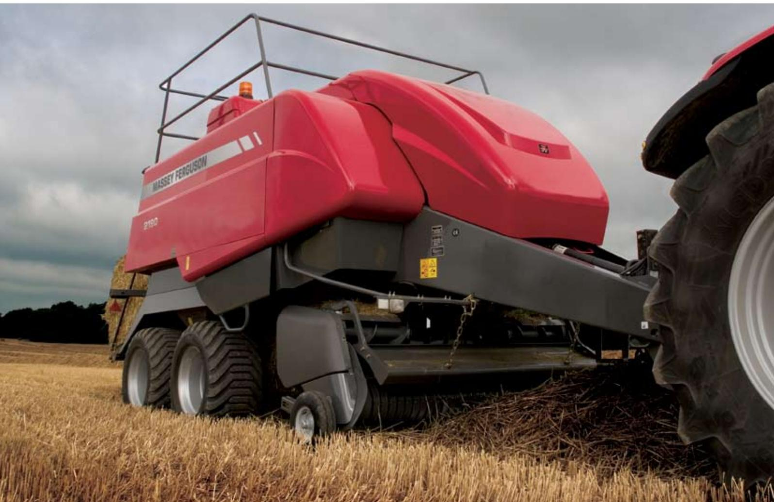
Ce dispositif hache la récolte à la longueur souhaitée, qui est ensuite poussée par l'empaqueteur pour remplir la chambre de précompression. L'entraînement de l'empaqueteur étant conservé, la qualité des plis n'est pas compromise.
