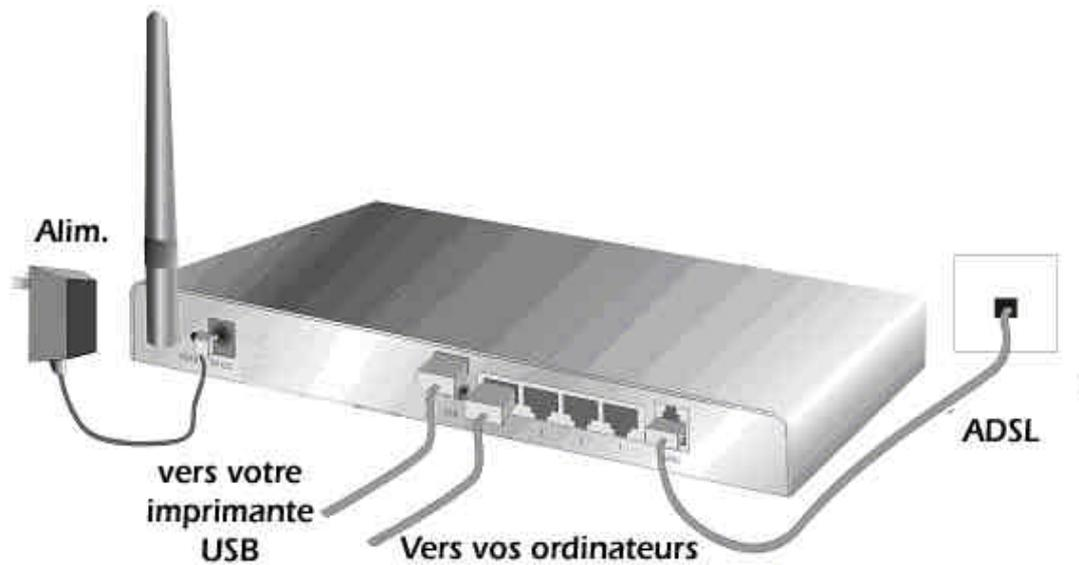
Figure 2-3 Paramétrage des connexion LAN et WAN.
