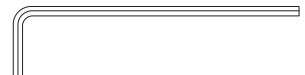
Clé à six pans de 1/4 po fournie pour changer la position des attaches de poignée (sur certains modèles)
