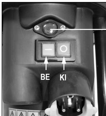
Visszaállító gomb (Motorvédelem)
