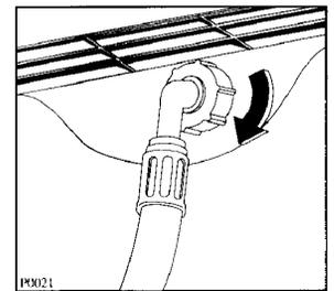
L'autre extrémité du tuyau d'arrivée, du côté de la machine, peut être orientée dans n'importe quelle direction. Dévisser un peu la bague de serrage, tourner le bout du tuyau et revisser solidement la bague.
