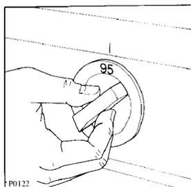
Enfoncer le bouton du thermostat et le tourner sur la température désirée.
