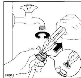
Si l'on remarque que la machine prend plus de temps à se remplir, il est conseillé de contrôler que le filtre du tuyau d'arrivée d'eau ne soit pas bouché.
