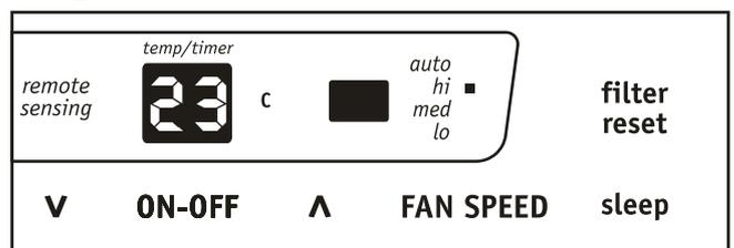
Remarque : Le contrôle peut afficher la température en degrés Fahrenheit ou en degrés Celsius.
