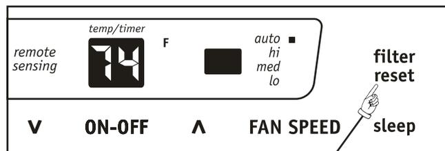
Remarque : Cette fonction est un rappel de nettoyage du filtre à air (Voir la section Entretien et Nettoyage) pour maximiser le fonctionnement. Le voyant s'allumera après 250 heures de fonctionnement. Pour réinitialiser la fonction après le nettoyage du filtre, appuyez sur le bouton de "Réinitialisation du Filtre", et le voyant s'éteint.
