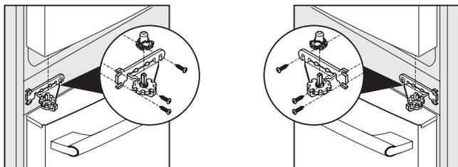
Une fois les deux portes en place, assurez-vous qu'elles sont bien alignées et de niveau (veuillez voir la section « Installation » pour plus de détails), et remplacez le couvre-charnière supérieur.
