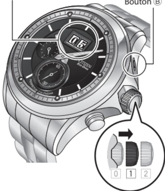
Les chiffres dans la fenêtre de la date bougent doucement vers la haut et vers le bas ou vers la droite et la gauche, ou changent pour vous indiquer que telle opération est possible.
