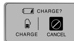
Utilisez le bouton ◀▶, ▶|| pour passer en mode charge <charge>, puis actionnez le bouton ARRET (■) pour sélectionner le mode charge <charge>. Le mode sélectionné (CHARGE <CHARGE> ou CANCEL <ANNULER>) démarre la charge automatiquement au bout d'une minute sans sélection de menu (lorsque le lecteur est raccordé à l'adaptateur CA).
