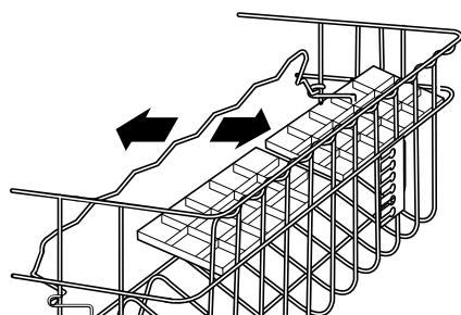
**Achtung:** Es ist unbedingt darauf zu achten, dass die Wasserzulauföffnung in der Mitte des oberen Korbes durch das Geschirr nicht abgedeckt wird.
