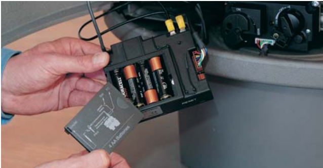
Remplacement des piles du récepteur
