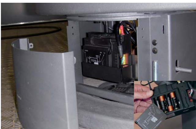
Vervangen van de batterijen van de ontvanger.
