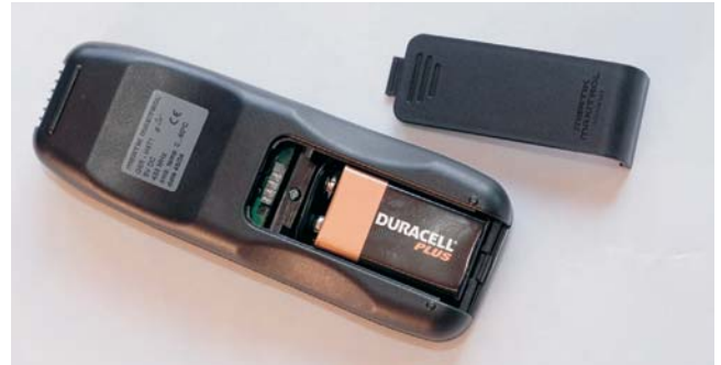
Remplacement du bloc-piles de la télécommande
