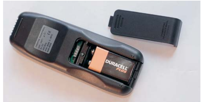
Auswechseln der Batterien in der Fernbedienung
