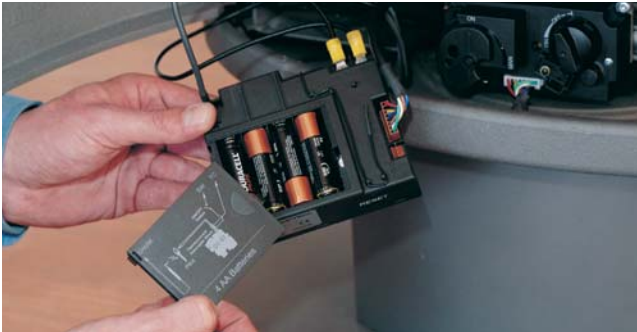
Auswechseln der Batterien im Empfänger
