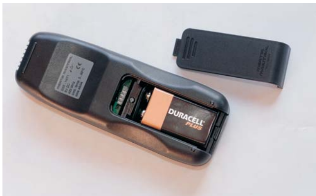
Remplacement du bloc-piles de la télécommande
