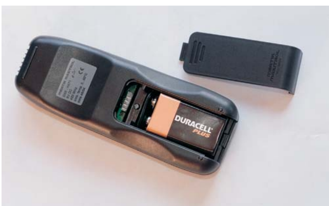
Vervangen van de batterij in de afstandsbediening.
