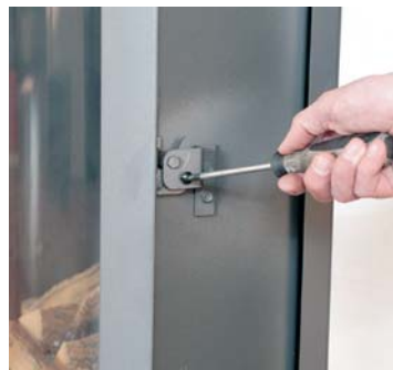
5: Entfernen Sie die Schraube in der Verriegelung.
