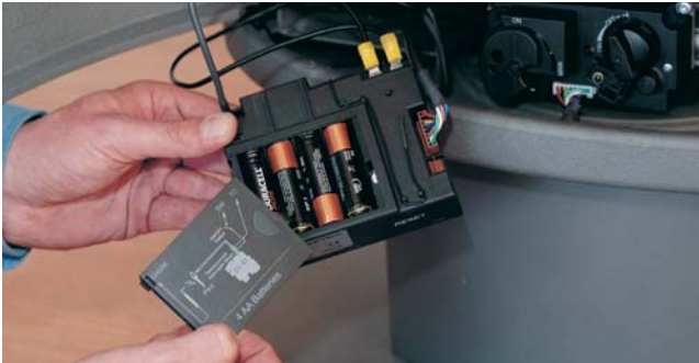
Vervangen van de batterijen van de ontvanger.
