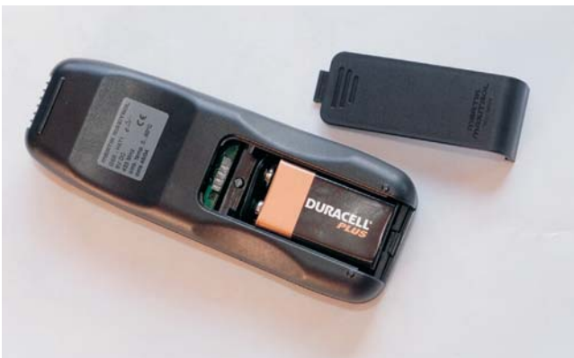
Auswechseln der Batterien in der Fernbedienung
