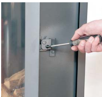
5. Verwijder de schroef in de vergrendeling.
