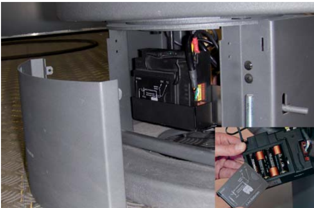
Auswechseln der Batterien im Empfänger
