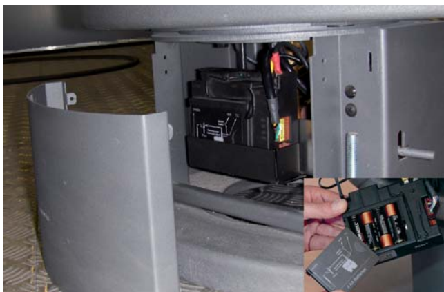
Remplacement des piles du récepteur
