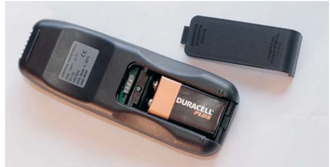
Vervangen van de batterij in de afstandsbediening.
