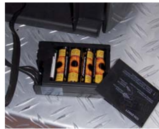
Remplacement des piles du récepteur
