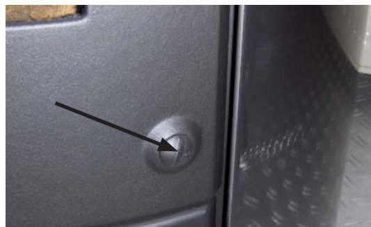
Losschroeven en openen deur
