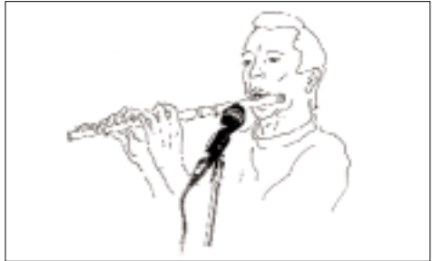
Abb. 5: Mikrofonaufstellung für Querflöte
