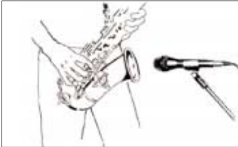
Fig. 6 : Position du micro pour le saxophone
