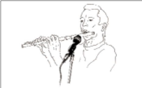
Fig. 5: Posicionamento do microfone para a flauta travessa
