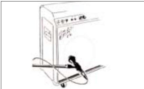
Fig. 9 : Position du micro pour amplis pour guitare
