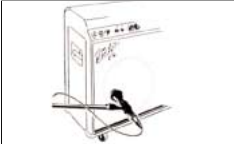
Abb. 9: Mikrofonaufstellung für Gitarrenverstärker
