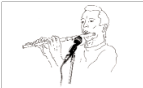
Fig. 5: emplazamiento del micrófono para flauta
