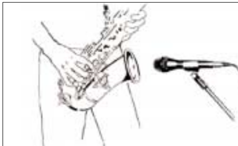
Fig. 6: Emplazamiento del micrófono para saxófono
