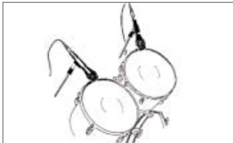
Abb. 10: Mikrofon- aufstellung für Tom-Toms
