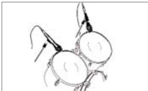
Fig. 8: Orientación del micrófono para tom-tom y roto-tom
