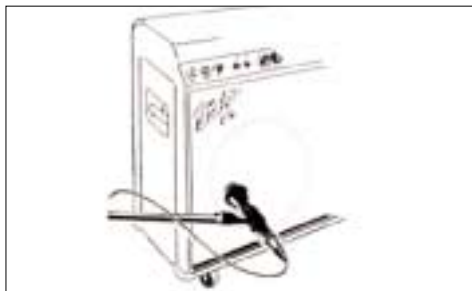
Fig. 9: Posizionamento del microfono per amplificatore per chitarra
