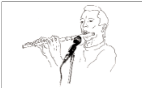
Fig. 5: Position du micro pour la flûte
