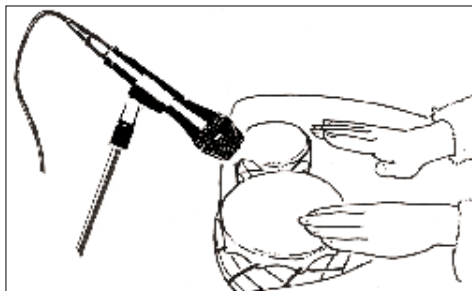
Abb. 8: Mikrofon- aufstellung für Bongos
