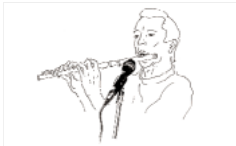
Fig. 5: Posizionamento del microfono per flauto traverso
