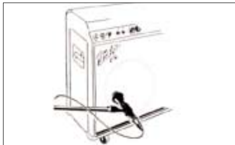
Fig. 9: Emplazamiento del micrófono para amplificador de guitarra
