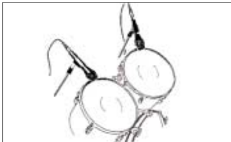
Fig. 7: Posizionamento del microfono per tom-tom
