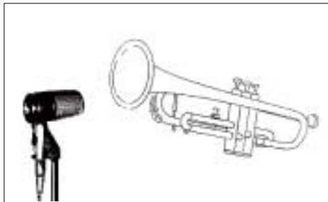
Fig. 5: Posição do microfone para o trompete.
