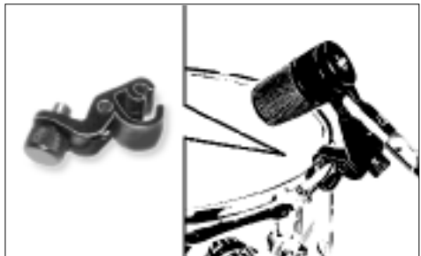
Abb. 7: Mikrofon am Tom-Tom befestigen
