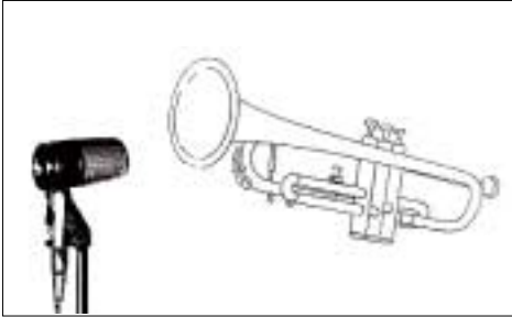
Abb. 5: Mikrofon- aufstellung für Trompete
