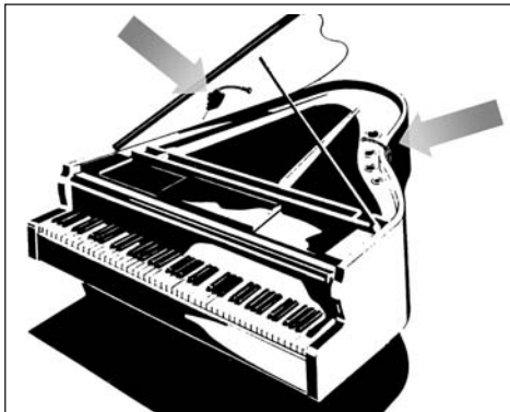
Abb. 9: Abnahme des Flügels mit zwei C 516 ML
