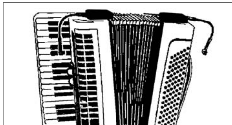
Fig. 6: Ripresa di fisarmonica con due C 516 ML
