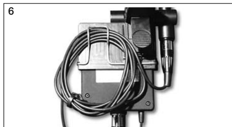
Fig. 4 : Enrouler et fixer le câble de raccordement
