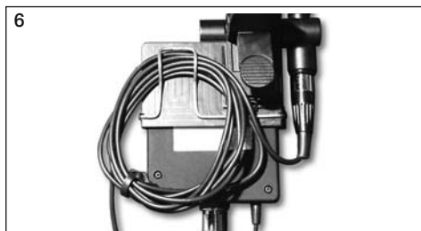
Fig. 4: Enrollar el cable de conexión y fijarlo
