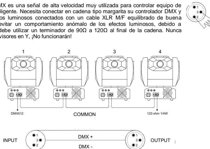
Cada efecto luminoso en la cadena necesita disponer de su propia dirección de inicio de forma que sepa qué comando del controlador debe descodificar.
