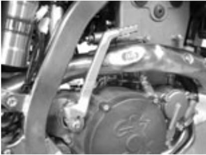
Passez du LOCTITE 243 sur la vis du levier de démarrage à pédale et ensuite vissez-la.
