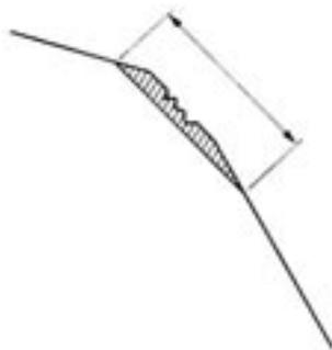
Si le siège de la soupape est rouillé ou brûlé, utilisez la lame de 45° pour finir l'entretien du siège.
