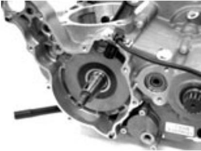
Démontez le rotor de l'alternateur avec l'outil spécial.
