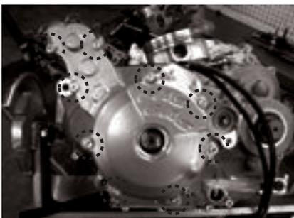
Vissez fermement les vis du couvercle du rotor de l'alternateur toujours dans le sens diagonal l'une de l'autre.
