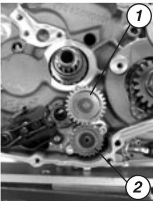
Démontez l'engrenage intermédiaire de la pompe à huile (1) et l'engrenage entraîné de la pompe à huile (2).
