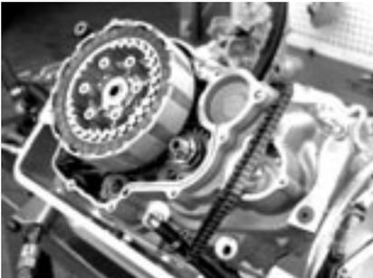
Introduire dans l'ordre indiqué les disques d'entraînement et les disques entraînés de l'embrayage un par un dans le moyeu de l'embrayage.
