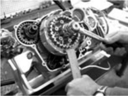
Retenez le moyeu de l'embrayage avec l'outil spécial et vissez l'écrou de celui-ci au couple de serrage indiqué.
