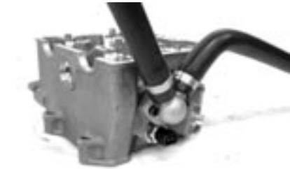
Démontez le support du tuyau du liquide de refroidissement du moteur.
