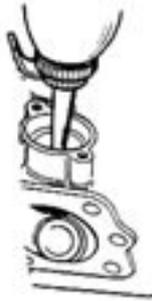
Une fois la soupape et le ressort montés, versez un petit d'essence à travers la voie d'admission ou d'échappement.
