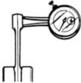
Mesurez le diamètre intérieur du pied de la bielle à l'aide d'un petit calibre. Si le diamètre intérieur du pied de la bielle dépasse la limite de service, remplacez la bielle par une bielle neuve.
