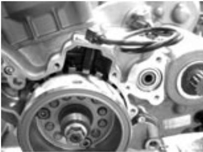
Tournez le rotor de l'alternateur jusqu'à ce que le 7e cran de la roue phonique soit aligné par rapport au milieu du trou du senseur de position.
