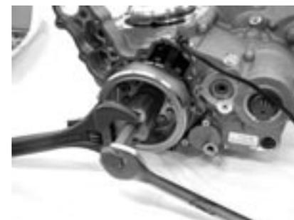
Enlevez l'écrou et la rondelle rotor de l'alternateur.
