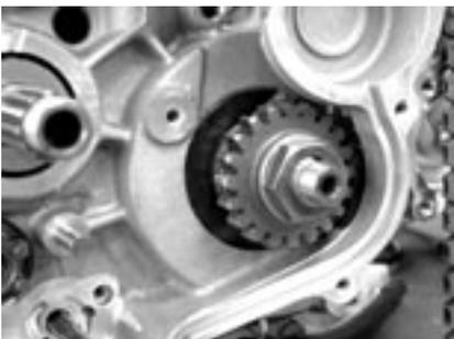
Enlevez l'écrou pignon vilebrequin, la rondelle, l'engrenage, la chaîne de distribution et l'engrenage de la chaîne de distribution.
