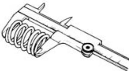
Mesurez la longueur libre de chacun des ressorts de l'embrayage à l'aide du calibre à vernier. Si l'un des ressorts ne se trouve pas dans la limite de service, remplacez tous les ressorts.
