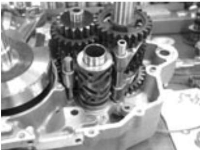
Montez les fourchettes du changement de vitesses dans les rainures du changement sur leurs positions et dans les sens corrects.
