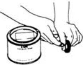
Passez de la graisse sur la lèvre des joints d'étanchéité.
