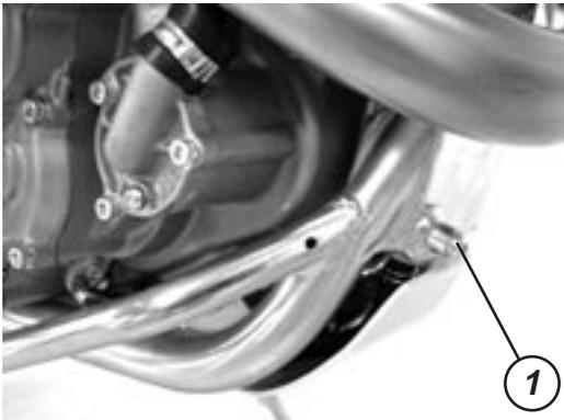
L'huile doit être remplacée tant que le moteur est chaud. Le filtre à huile doit être remplacé avec la même fréquence de l'huile du moteur.
