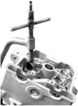
Comprimez les ressorts de la soupape et ensuite enlevez les demi-cônes de la tige de la soupape à l'aide des outils spéciaux.
