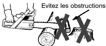
Dégager l'endroit du travail
