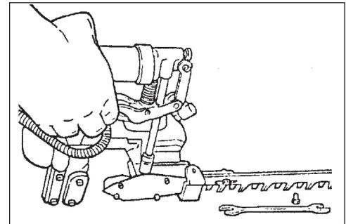
**DÉPOSE/INSTALLATION DU RAIDISSEUR DE LAME**
