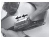
Poussez l'unité de contrôle avec le pouce
