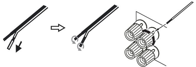
Il est recommandé d'utiliser des fiches bananes (4 mm standard) raccordées au câble d'enceinte pour l'insertion directe dans les bornes d'enceintes.
