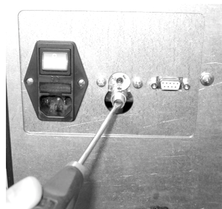
Comment réarmer le thermostat à boule une fois que le poêle est froid.
