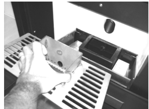
Extraction du pot de combustion pour le nettoyage
