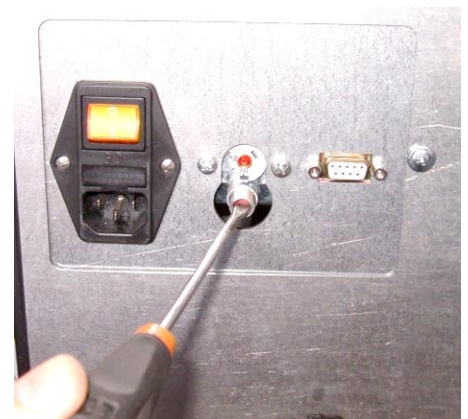
Fig. 25 - Comment réarmer le thermostat à boule une fois que la poêle est froide.
