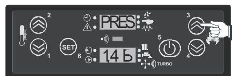
Contrôle de la pression de l'installation
