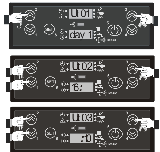
Séquence pour accéder au menu de réglage heure et minutes
