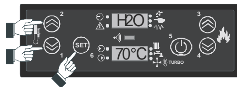
Réglage température pression de l'installation
