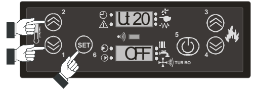
Activation du thermostat extérieur et conséquente désactivation du thermostat intérieur
