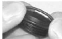
Fig. 152 - Position du joint de l'émetteur.
