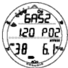
Fig. 96 - Deuxième affichage secondaire palier de décompression.
