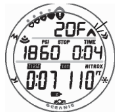
Fig. 92B - Palier de décompression. (après accusé de réception)
