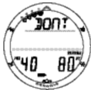
Fig. 106 - Alarme "Ne pas changer de gaz".
