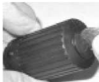
Fig. 147 - Ouverture du compartiment pile de l'émetteur.
