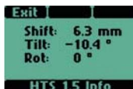
Les paramètres HTS s'affichent sur l'écran LCD de l'appareil et sont inclus dans le fichier image.
