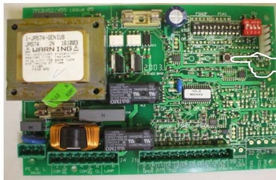
Appuyer sur le poussoir **F** jusqu'à ce que le 1er vantail démarre en ouverture
