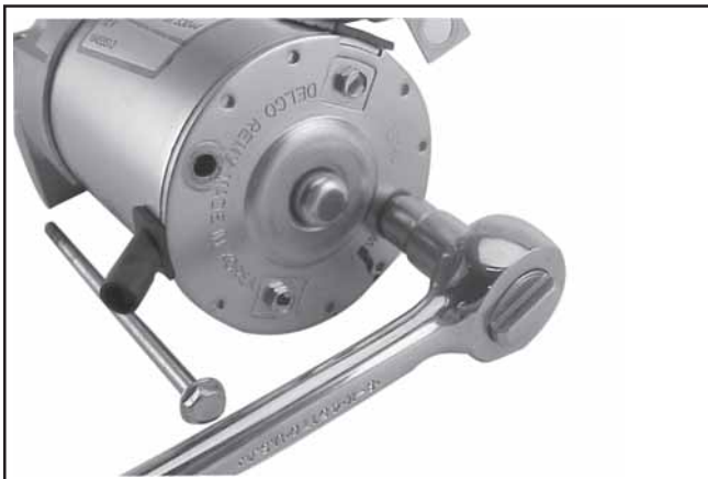
Figure 8-44. Dépose des boulons.
