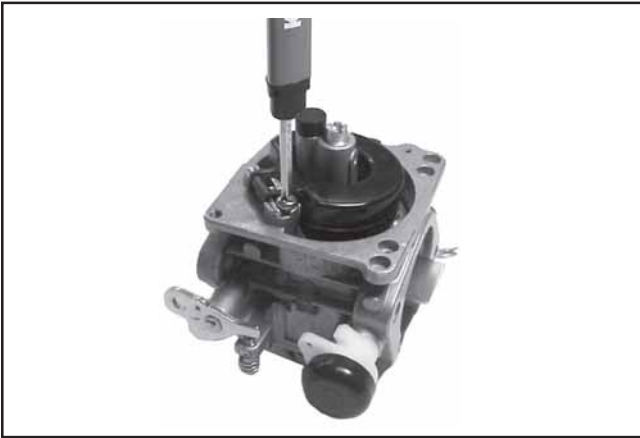
Figure 5-11. Installation du flotteur.
