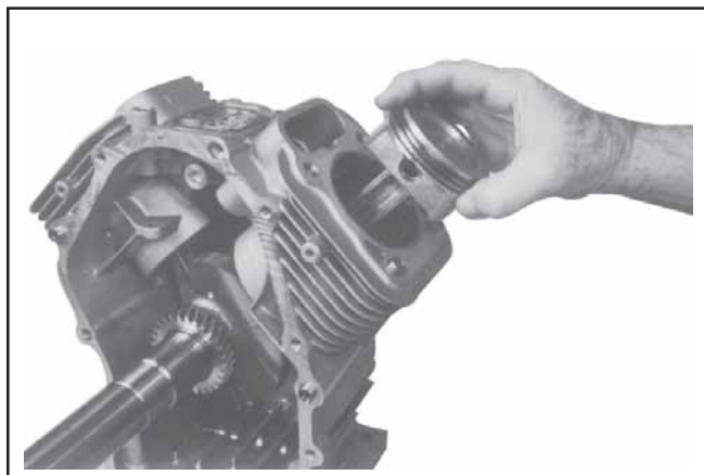
Figure 9-55. Dépose de la bielle et du piston.
