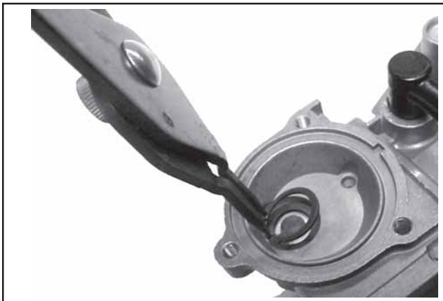
Figure 5-28. Dépose de la bague de maintien.
