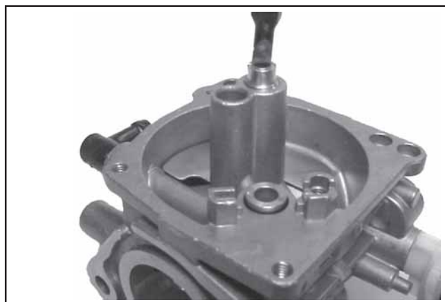
Figure 5-17. Installation de la buse principale et du gicleur principal.
