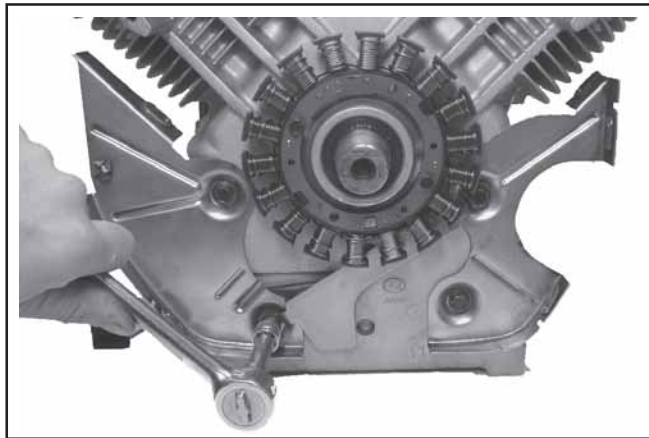
Figure 9-47. Dépose des plaques de support et du couvercle du câble du stator.
