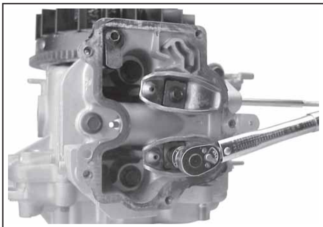
Figure 11-39. Installation de goujons de montage neufs à la hauteur recommandée.
