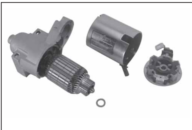
Figure 8-46. Dépose du châssis du démarreur.
