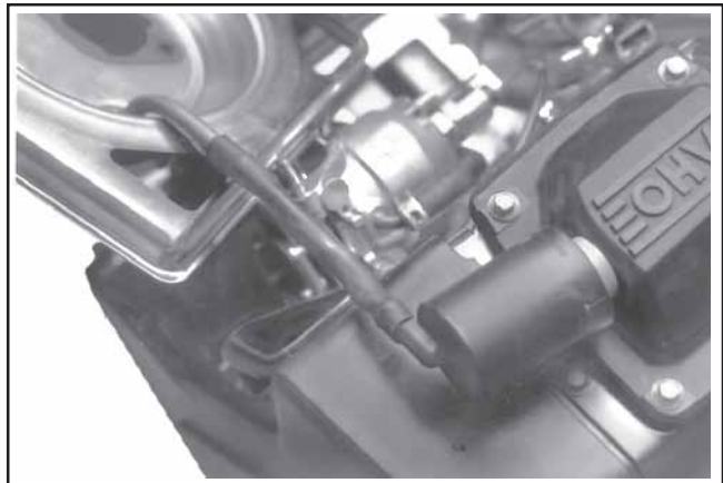
Figure 9-8. Dépose de l'élément et du pré-filtre des tondeuses commerciales.
