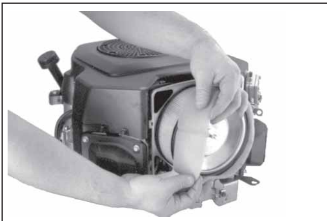
Figure 4-3. Pré-filtre sur filtre à air standard.
