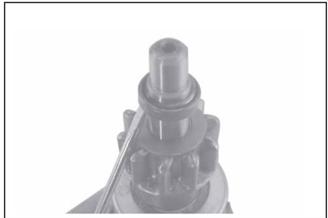
Figure 8-57. Installation du collier d'arrêt et de la coupelle.
