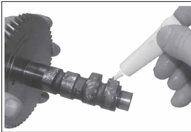
Figure 11-12. Appliquer du lubrifiant pour arbre à cames sur les bossages des engrenages.
