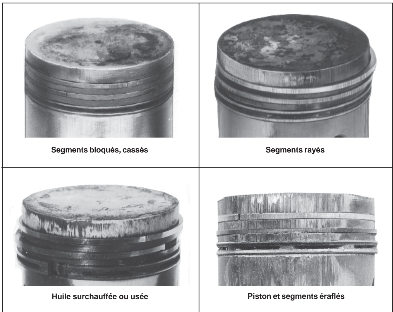
Figure 10-8. Types d'endommagements de piston les plus courants.
