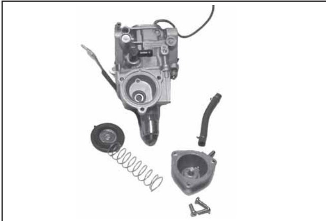
Figure 5-27. Couvercle et membrane de la pompe d'accélération retirés.
