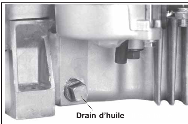
Figure 6-4. Bouchon de vidange d'huile (côté démarreur).
