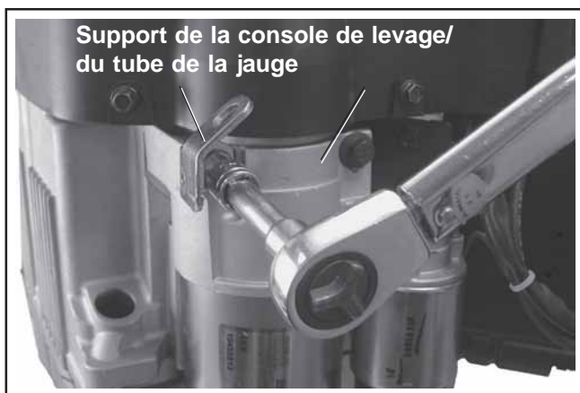
Figure 11-75. Installation du démarreur et de la console de levage.
