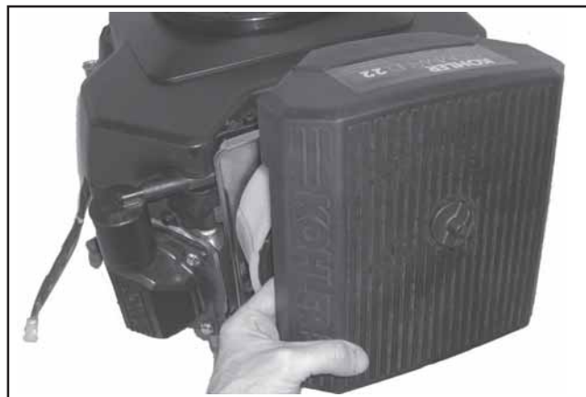
Figure 9-5. Dépose du couvercle du filtre à air standard.
