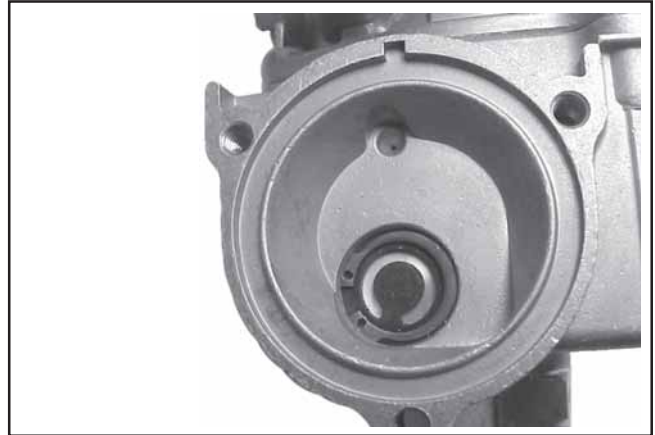
Figure 5-29. Vanne d'arrêt et bague de maintien installées.
