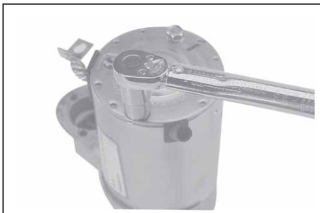
Figure 8-67. Serrage des boulons.
