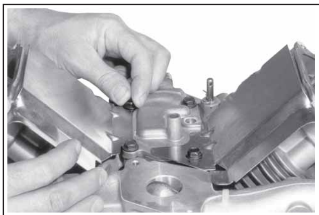
Figure 11-56. Serrer avec les doigts les deux vis du couvercle restantes.
