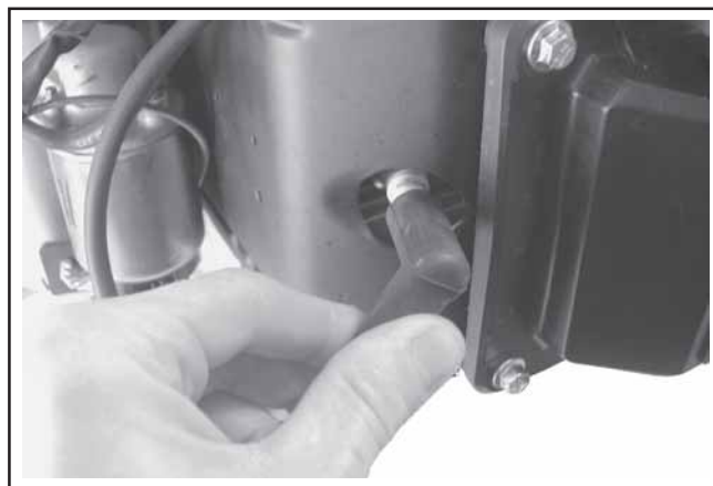
Figure 11-85. Brancher les câbles des bougies.
