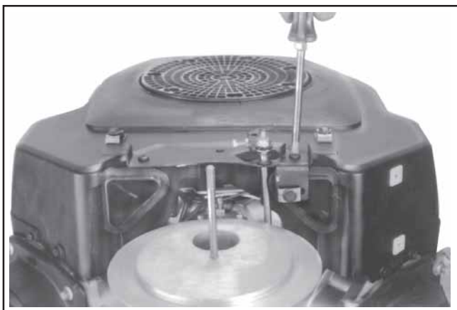
Figure 9-11. Dépose du panneau de commande.
