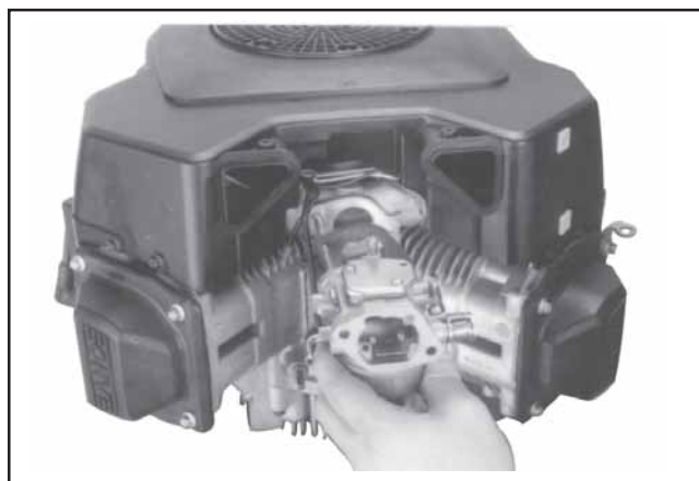
Figure 11-67. Installation du carburateur, de la tringle de l'accélérateur et du levier du régulateur.
