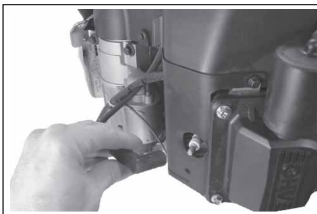
Figure 9-1. Débranchement des câbles des bougies.
