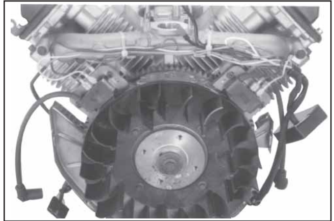
Figure 9-33. Position des modules d'allumage.
