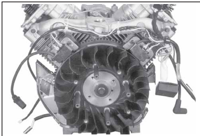
Figure 11-52. Connecter les câbles des modules d'allumage SMART-SPARK™.
