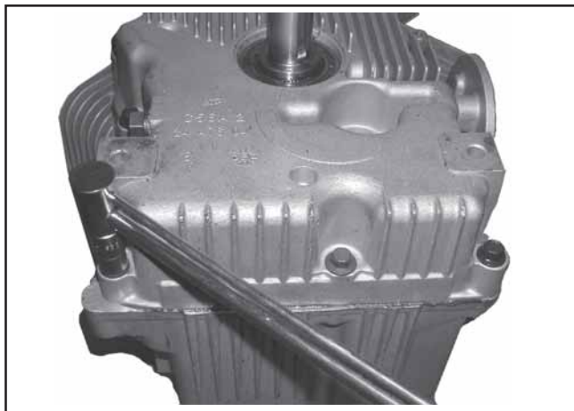
Figure 11-19. Couple de serrage des fixations du carter inférieur.
