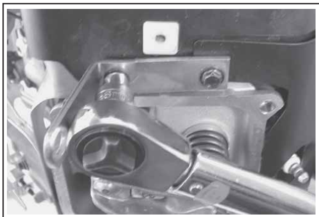
Figure 11-60. Serrage des vis avant des chicanes externes.
