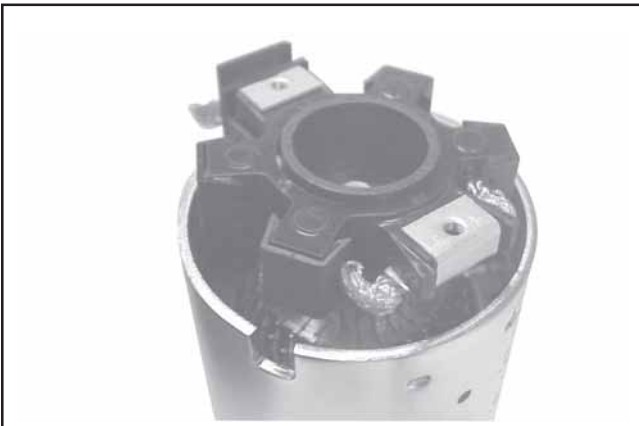
Figure 8-63. Installation du support de balais avec tube fourni.
