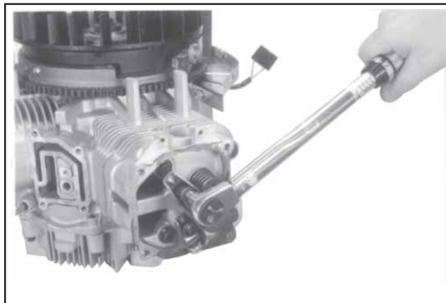
Figure 11-37. Serrage des fixations des culasses.
