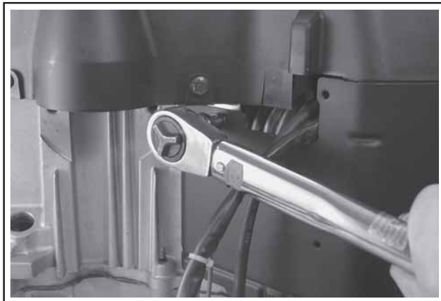
Figure 11-61. Serrage des vis courtes des chicanes externes.
