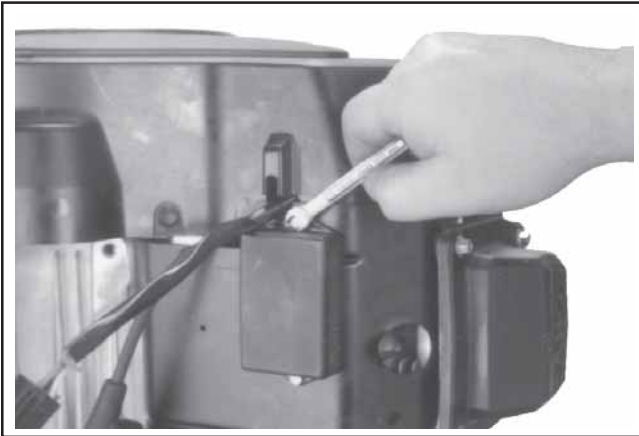
Figure 9-21. Dépose du module d'avance à l'allumage (sur certains modèles).
