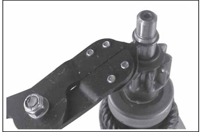
Figure 8-50. Dépose de la bague de maintien.
