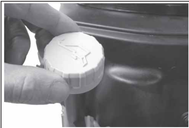
Figure 9-2. Dépose du bouchon de remplissage d'huile/de la jauge.
