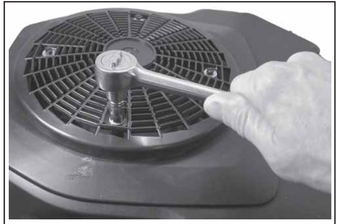
Figure 9-24. Dépose de la grille du volant.
