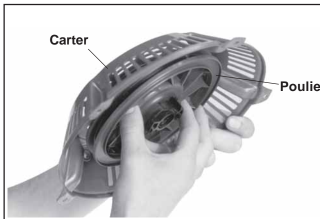
Figure 7-6. Dépose de la poulie du carter.
