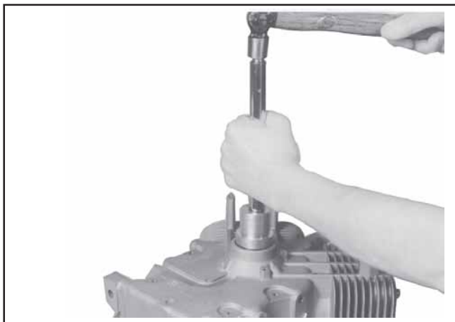
Figure 11-2. Installation du joint d'huile dans le carter du moteur.
