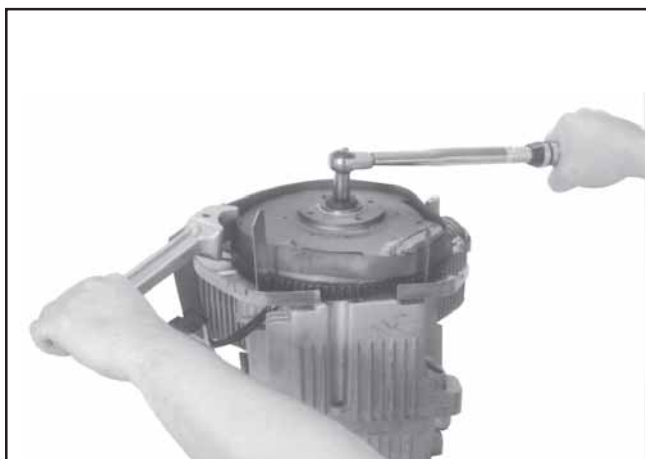
Figure 11-25. Montage et serrage de la fixation du volant.
