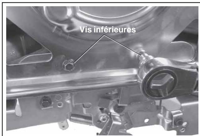
Figure 11-82. Serrage des vis de la console/base inférieure (certains modèles).
