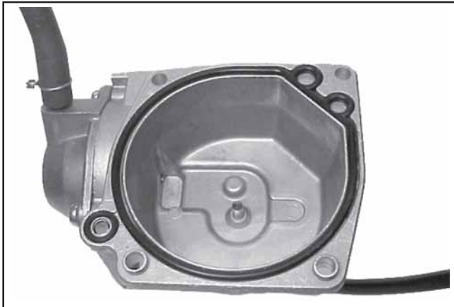
Figure 5-23. Installation des joints toriques de la cuve de carburant.
