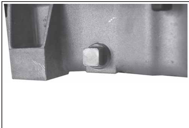
Figure 11-84. Installation du(des) bouchon(s) de vidange de l'huile.
