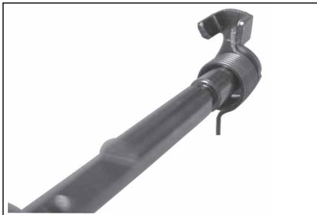
Figure 5-35. Éléments de la tige et du ressort du starter.
