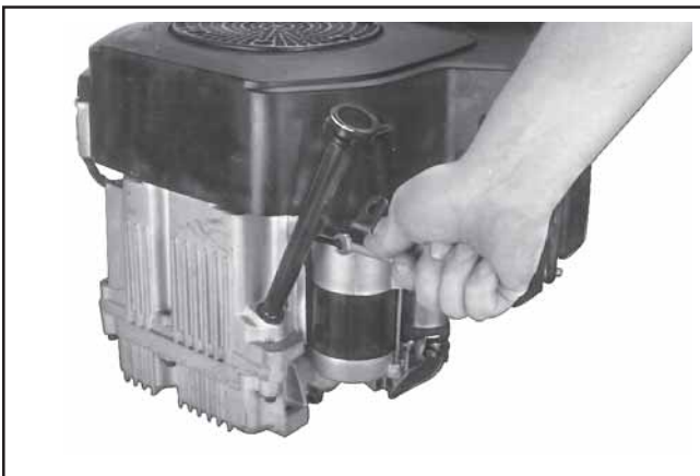
Figure 9-3. Dépose de la console du tube de remplissage d'huile.
