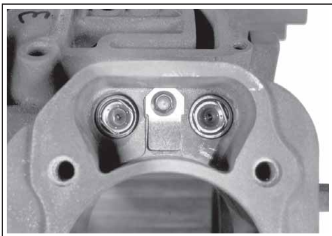
Figure 11-33. Tige du reniflard en place.
