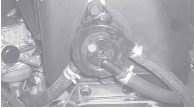
Figure 11-77. Pompe à carburant réinstallée.
