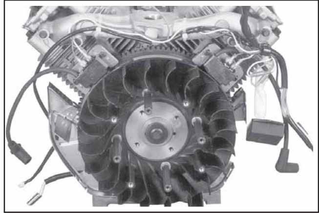
Figure 8-6. Système d'allumage à décharge capacitive avec avance à l'allumage.
