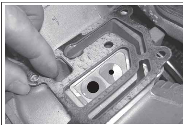
Figure 9-30. Dépose du joint du couvercle du reniflard.
