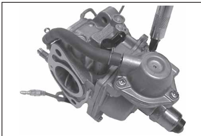
Figure 5-31. Montage du flexible et des vis du carter de la pompe d'accélération.
