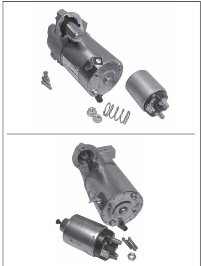
Figure 8-42. Démontage du solénoïde du démarreur.
