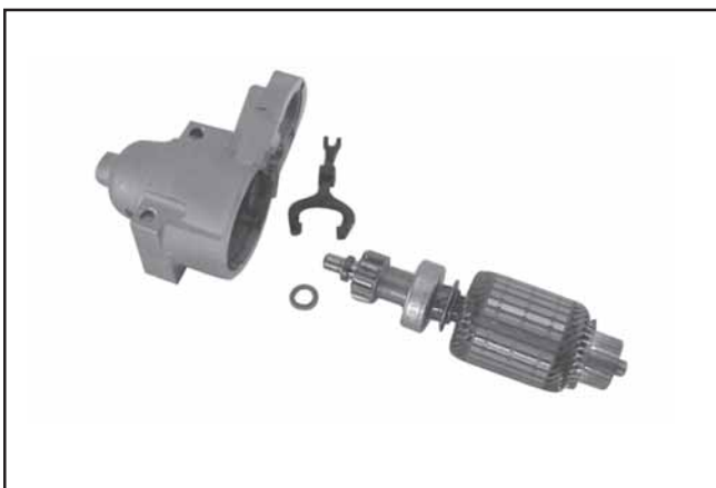
Figure 8-48. Armature et levier retirés.
