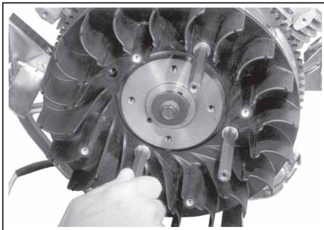
Figure 11-28. Mise en place des supports de la grille en métal.
