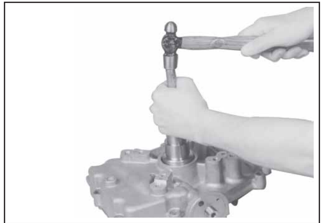
Figure 11-15. Installation du joint d'huile dans le carter inférieur.
