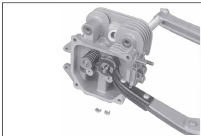
Figure 9-40. Dépose des soupapes avec l'outil de compression de ressort de soupape.
