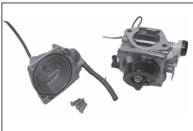
Figure 5-8. Cuve de carburant retirée du carburateur.
