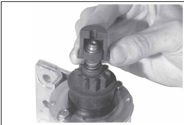
Figure 8-34. Montage de la plus grande moitié autour de la fixation du ressort.
