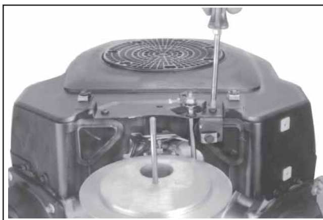
Figure 11-71. Installation du panneau de commande.
