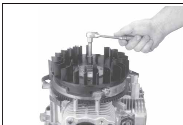
Figure 9-44. Dépose du ventilateur.
