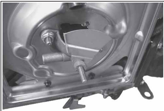
Figure 4-7. Dépose de la plaque de base d'un filtre standard.
