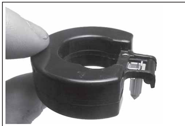
Figure 5-20. Flotteur et pointeau d'admission.
