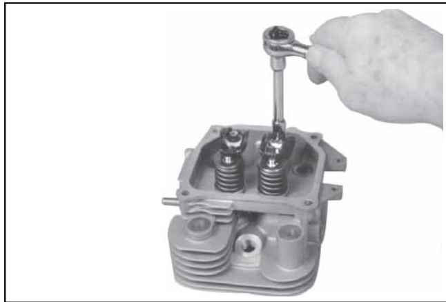
Figure 9-39. Dépose du culbuteur.
