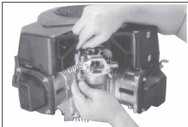
Figure 11-69. Installation des commandes externes du régulateur.
