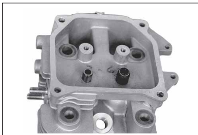
Figure 11-34. Emplacement du joint de la soupape d'admission.
