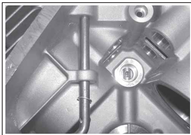
Figure 11-5. Installation de l'arbre intermédiaire de 8 mm du régulateur.
