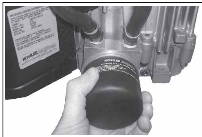
Figure 11-83. Installation et serrage du filtre à huile.
