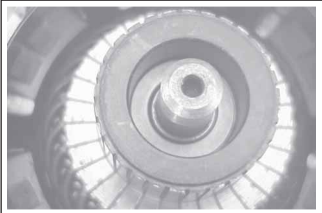
Figure 8-62. Installation de la rondelle de butée.
