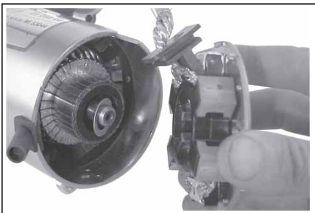
Figure 8-45. Dépose de la plaque d'extrémité du commutateur.
