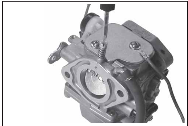
Figure 5-25. Installation du ressort et de la vis de réglage du carburant.
