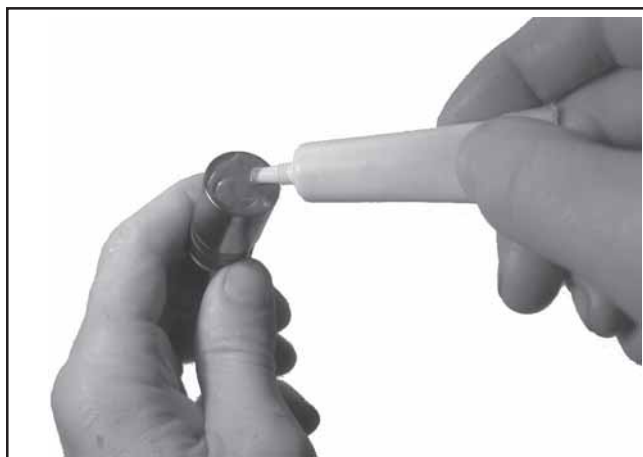
Figure 11-30. Appliquer du lubrifiant pour arbres à cames à la base des poussoirs.
