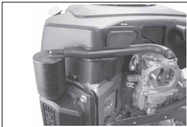
Figure 11-80. Tuyau du reniflard et séparateur.
