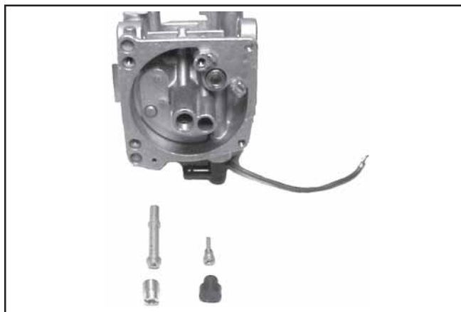
Figure 5-16. Gicleur principal et gicleur de ralenti retirés.
