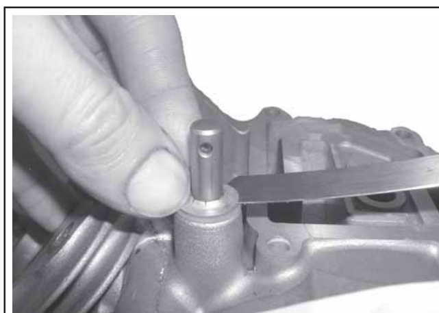
Figure 11-6. Installation de la broche de l'arbre intermédiaire du régulateur (arbre de 8 mm).
