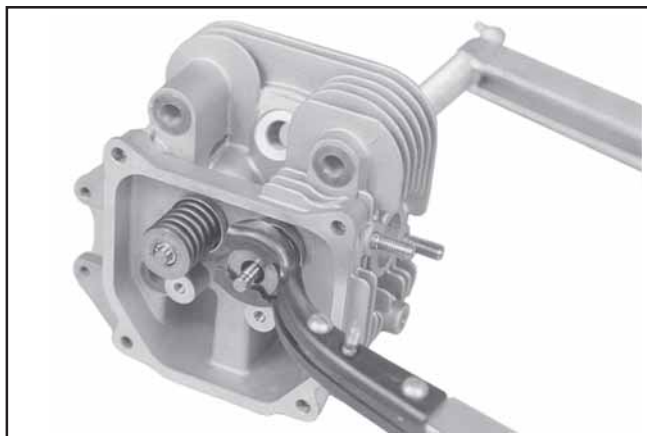
Figure 11-36. Installation des soupapes avec l'outil de compression de ressort de soupapes.
