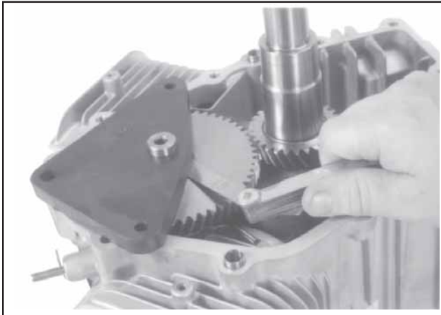
Figure 11-14. Contrôle du jeu axial de l'arbre à cames.
