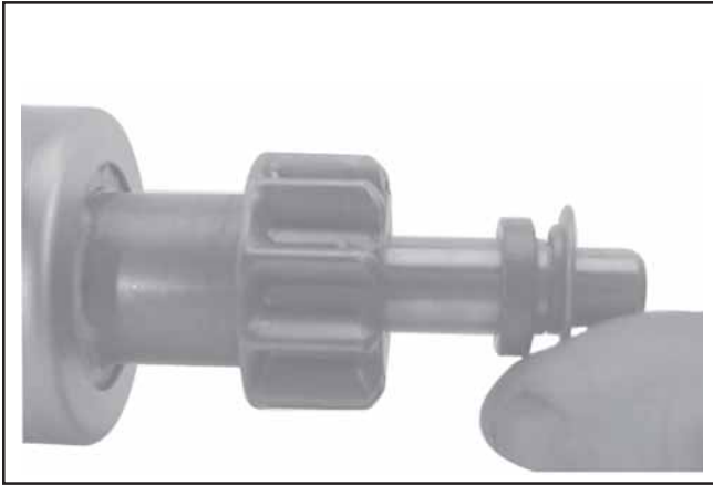
Figure 8-58. Installation de la rondelle de butée.
