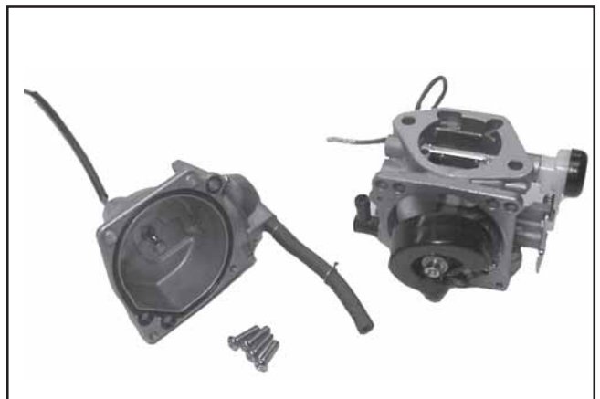
Figure 5-14. Cuve de carburant retirée du carburateur.
