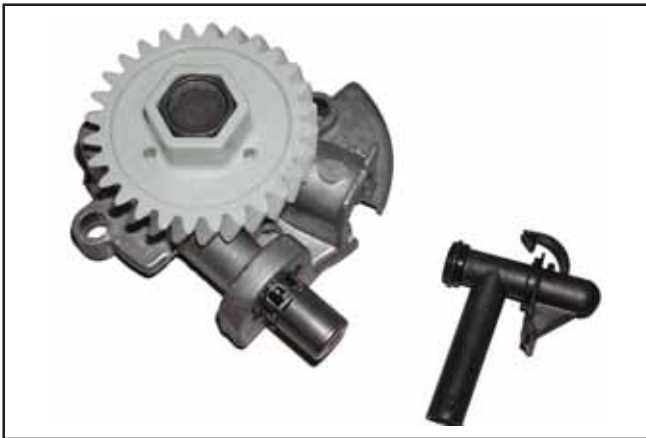
Figure 10-17. Pompe à huile, dispositif d'aspiration d'huile en plastique et soupape de décharge en une seule unité (modèle le plus récent).
