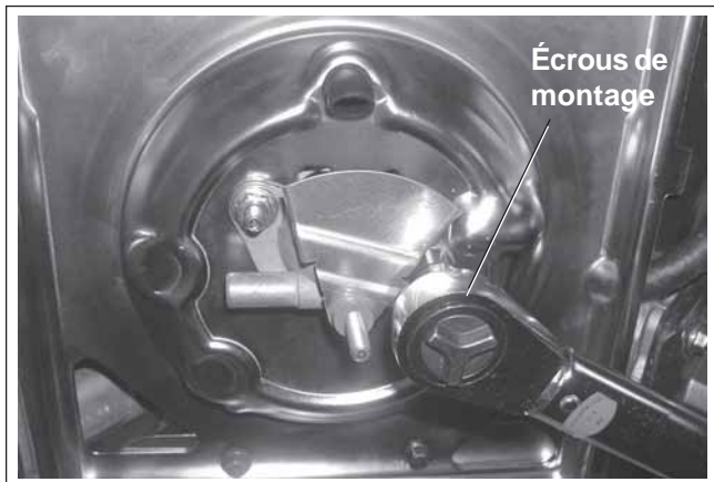
Figure 11-81. Serrage des écrous de montage de la base et de la coupelle de refoulement.
