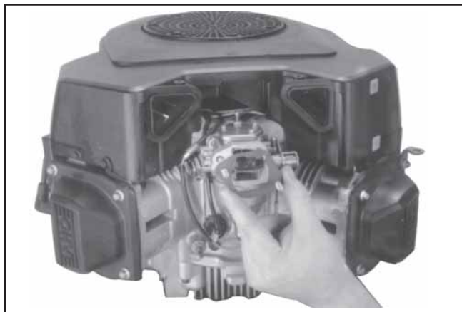
Figure 9-18. Dépose du carburateur.
