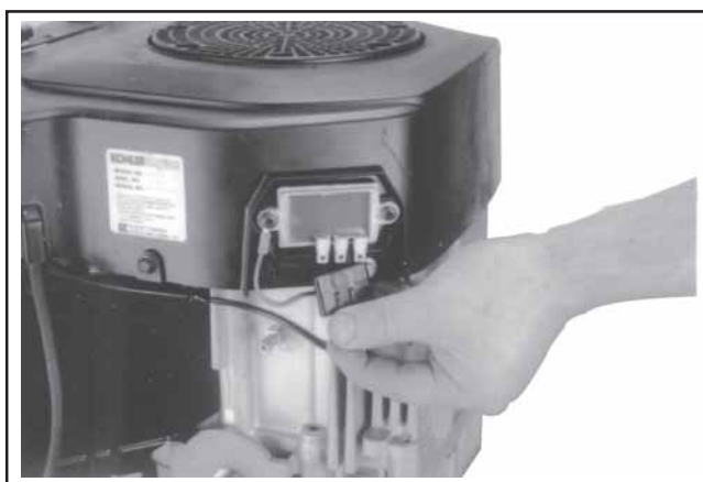
Figure 11-65. Installation du redresseur-régulateur.
