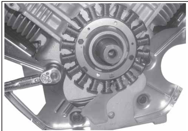
Figure 11-22. Installation des plaques de support et du couvercle du câble du stator.
