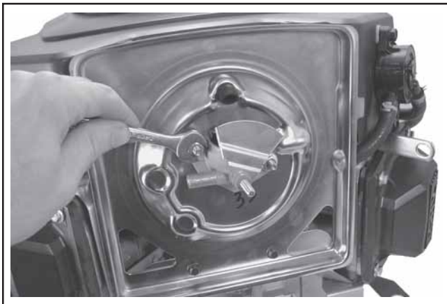
Figure 9-7. Dépose de la base du filtre à air standard.
