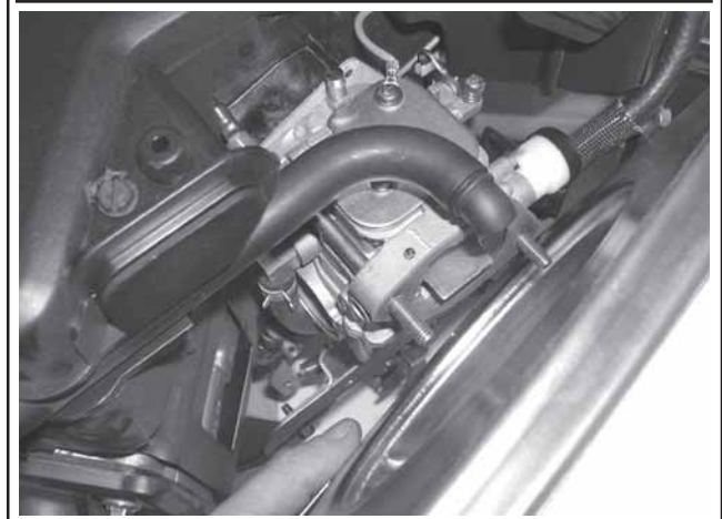
Figure 9-9. Débranchement du tuyau du reniflard de la base.
