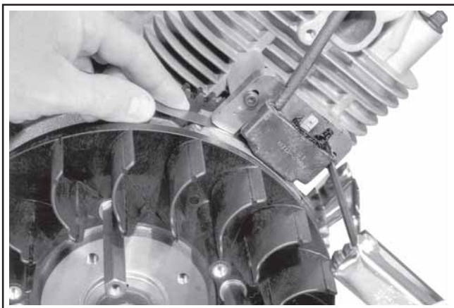
Figure 11-46. Réglage du jeu du module d'allumage.
