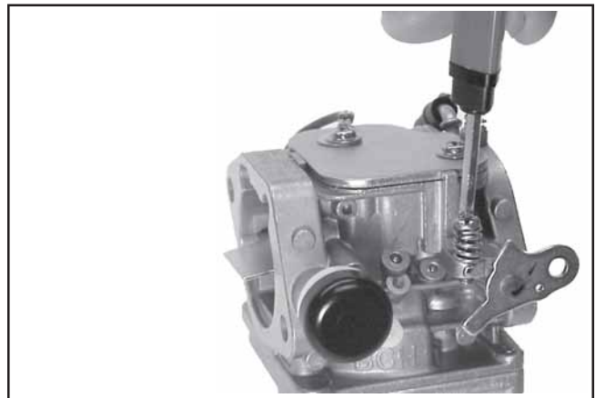
Figure 5-26. Installation du ressort et de la vis de réglage du ralenti.
