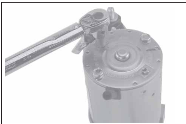
Figure 8-68. Serrage des vis du support de balais.
