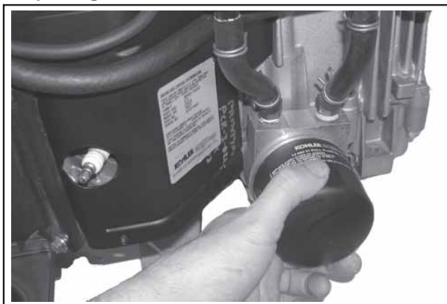
Figure 9-4. Dépose du filtre à huile.
