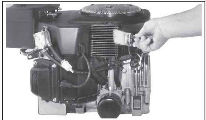
Figure 6-7. Radiateur d'huile monté sur le carter du ventilateur.
