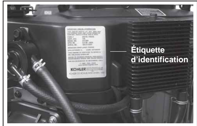
Figure 1-1. Emplacement de l'étiquette d'identification du moteur.
