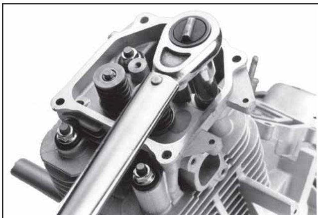
Figure 11-40. Serrage des écrous de montage de la culasse (version avec goujons).
