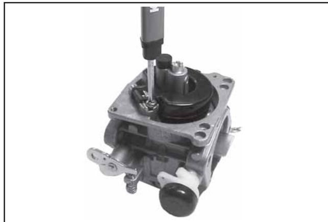
Figure 5-21. Installation de l'ensemble du flotteur.
