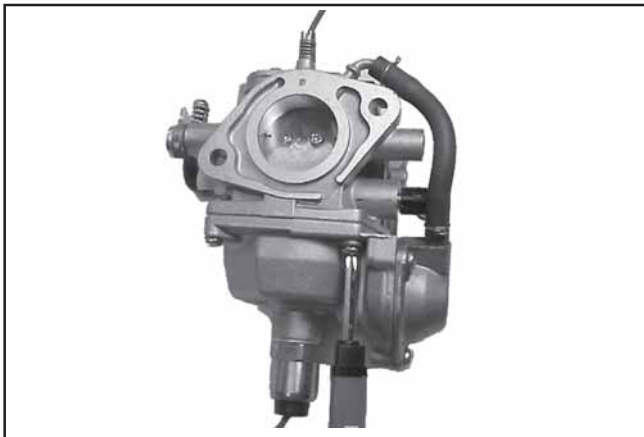
Figure 5-24. Installation de la cuve de carburant.
