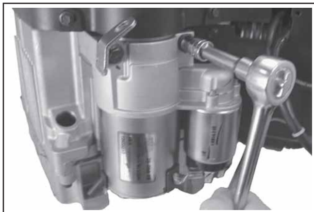
Figure 9-19. Dépose du moteur du démarreur électrique.
