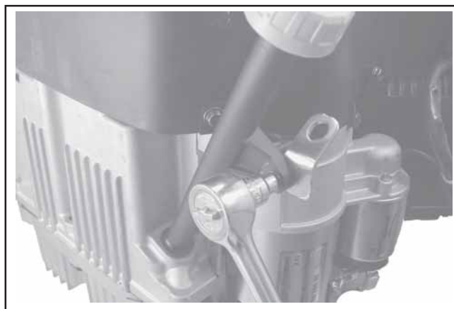
Figure 11-76. Installation du tube de la jauge.
