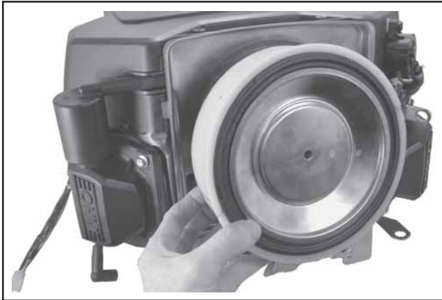
Figure 9-6. Dépose de l'élément et du pré-filtre standard.
