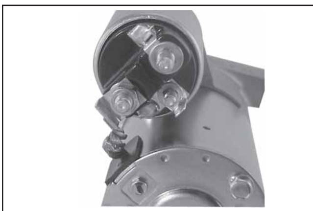
Figure 8-69. Connexion du câble positif (+) de balais.
