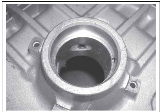
Figure 11-1. Trou du joint du carter du moteur.
