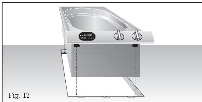
– **Réalisez la découpe** dans votre plan de travail pour un ou plusieurs appareils Vario. Pour ce faire, basez-vous sur le schéma de pose et le tableau des cotes. Ce dernier indique l'encombrement de la barrette de jonction entre les appareils. **Important !** L'angle entre la surface de coupe et le plan de travail doit être de 90° (fig. 15).
