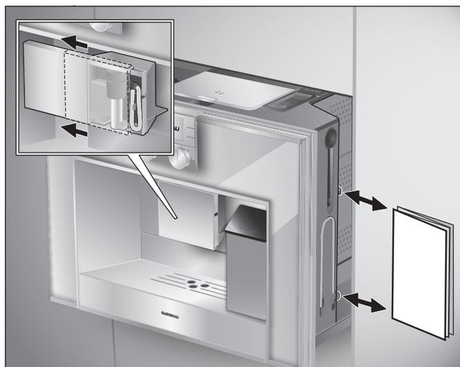
La machine à café automatique est équipée de logements spéciaux, pour ranger les accessoires et le Memento. Ils se trouvent du côté droit et sont accessibles lorsque la machine est en position d'extraction 1 (voir point « Système d'extraction »).
