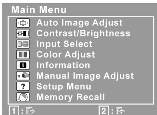
**REMARQUE :** tous les menus et écrans de réglage OSD disparaissent automatiquement après environ 15 secondes. Vous pouvez régler ce délai par le biais du paramètre "Temps d'attente de l'écran" du menu de configuration.
