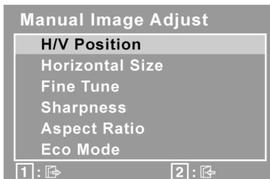
**H./V. Position (Position Horizontale/Verticale)** déplace la position de l'image à gauche ou à droite et en haut ou en bas.
