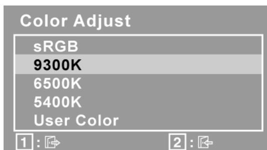
**sRGB**-est en train de devenir rapidement le standard de l'industrie pour la gestion des couleurs, et la plupart des applications récentes sont compatibles avec ce format. L'activation de ce paramètre permet à l'écran LCD d'afficher des couleurs plus fidèles à l'original. L'activation du paramètre sRGB entraîne la désactive les réglages du contraste et de la luminosité.
