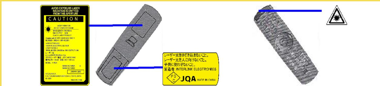
Cette télécommande comporte un pointeur laser pour remplacer le doigt ou une baguette. Le faisceau laser se met en marche lorsque vous appuyez sur le bouton LASER, et le TÉMOIN LASER s'allume alors.
