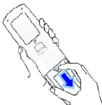
**2** Insérez les piles. Alignez et insérez les deux piles LR06 en respectant la polarité des piles telle qu'elle (est indiquée dans la télécommande).
