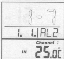
Affichage lors du réglage des fins de semaine - alarme 2 Alarme – lundi à dimanche
