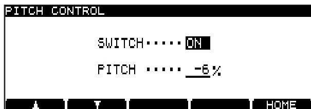
Figure 4.2: Commande de hauteur (Pitch control)
