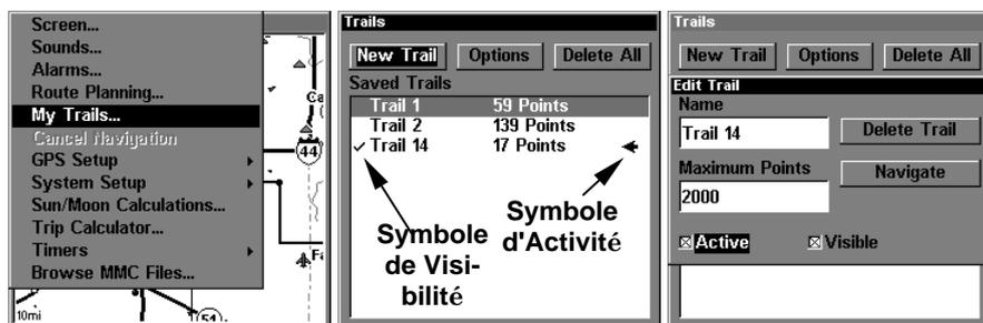
Étapes pour sauvegarder un tracé et en commencer un nouveau. A gauche, commande des Tracés. Au centre, Menu des Tracés. La flèche de droite du Tracé 14 indique que le tracé est "actif", et la marque à gauche indique que le tracé est visible sur la carte. La figure de droite illustre le menu d'Édition du Tracé, avec la commande Active sélectionnée.
