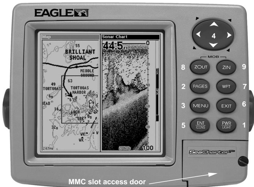
**Appareil sonar/GPS SeaCharter 480DF, vu de face, montrant l'écran partagé avec la carte et le sonar, le clavier et la trappe d'accès pour la carte MMC.**
