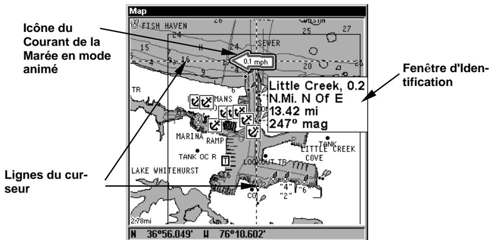
Graphique Navionics montrant l'icône du Courant de la Marée sélectionnée par le curseur. Dans cet exemple, la marée est haute mais elle est sur le point de redescendre. Le courant se déplace vers l'ouest à une vitesse de 0.1 mph.
