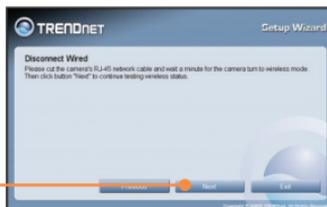
**Remarque :** The TV-IP501W ne fonctionnera sans fil que lorsque vous aurez débranché le câble Ethernet à l'arrière de la caméra.
